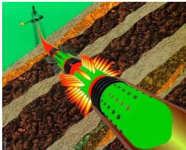
Imagem 10 - Ilustração do processo de canhoneio
