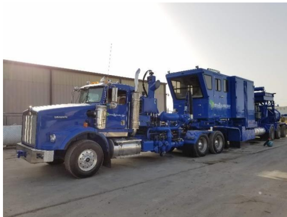
Imagem 6 - Unidade própria de Fraturamento Hidráulico da PetroReconcavo
