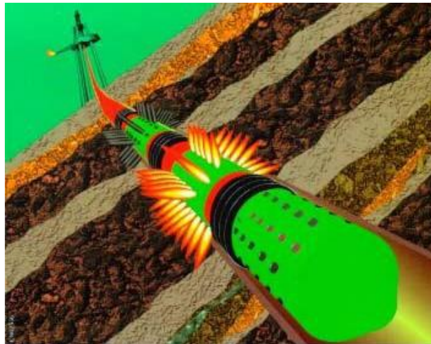
Imagem 10 - Ilustração do processo de canhoneio
