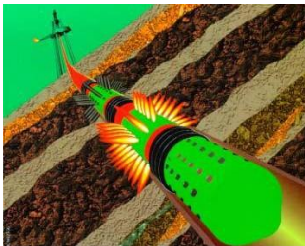
Imagem 10 - Ilustração do processo de canhoneio
