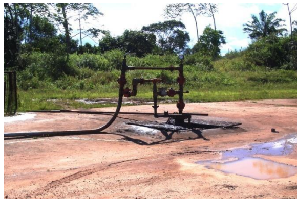
Imagem 9 - Poço equipado com Bomba Eletro Submersível
