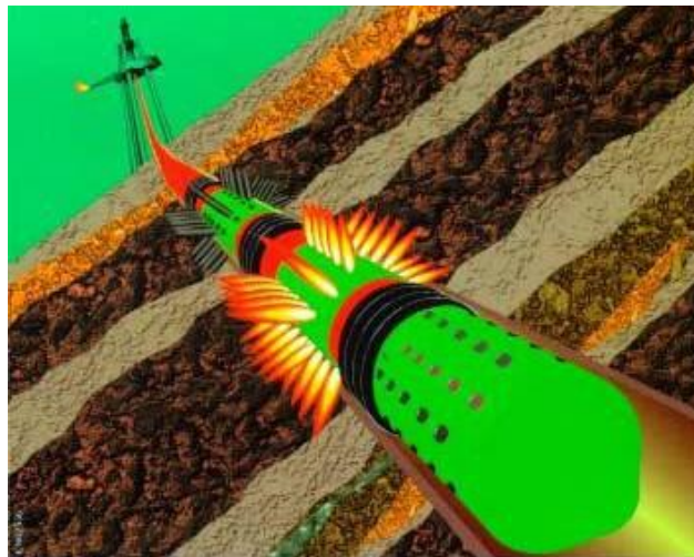
Imagem 10 - Ilustração do processo de canhoneio
