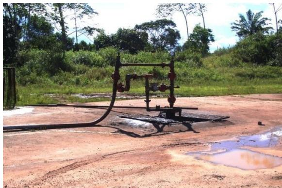
d) Gás Lift: método de elevação artificial de petróleo onde gás é injetado continuamente com o objetivo de diminuir a componente hidrostática da perda de carga durante o escoamento do fluido através da coluna de produção, provocando uma diminuição no gradiente de pressão ao longo da tubulação. Outro método é a injeção de gás de forma intermitente elevando o fluido por meio de golfadas. O resultado é um aumento da vazão de produção.
