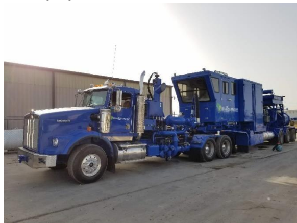
Imagem 6 - Unidade própria de Fraturamento Hidráulico da PetroReconcavo
